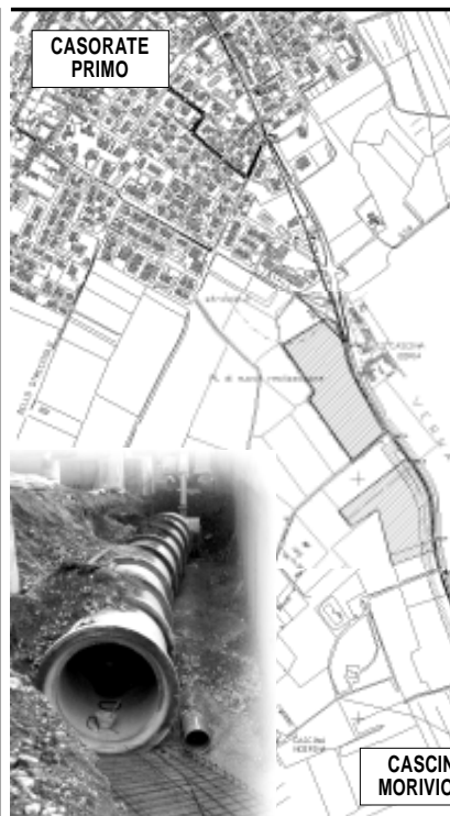
Nell'immagine qui sopra una parte del progetto elaborato dall'ASM Pavia che prevede la costruzione di nuove fognature ed il collegamento della rete fognaria alla roggia Cina, dal centro abitato fino alla Cascina Morivione, situata a sud di Casorate Primo.
